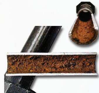
Corte de una tubería de fierro negro de aire comprimido. Se puede observar la acumulación típica de contaminantes que pueden llegar a bloquear el flujo de aire en pocos años de operación.
