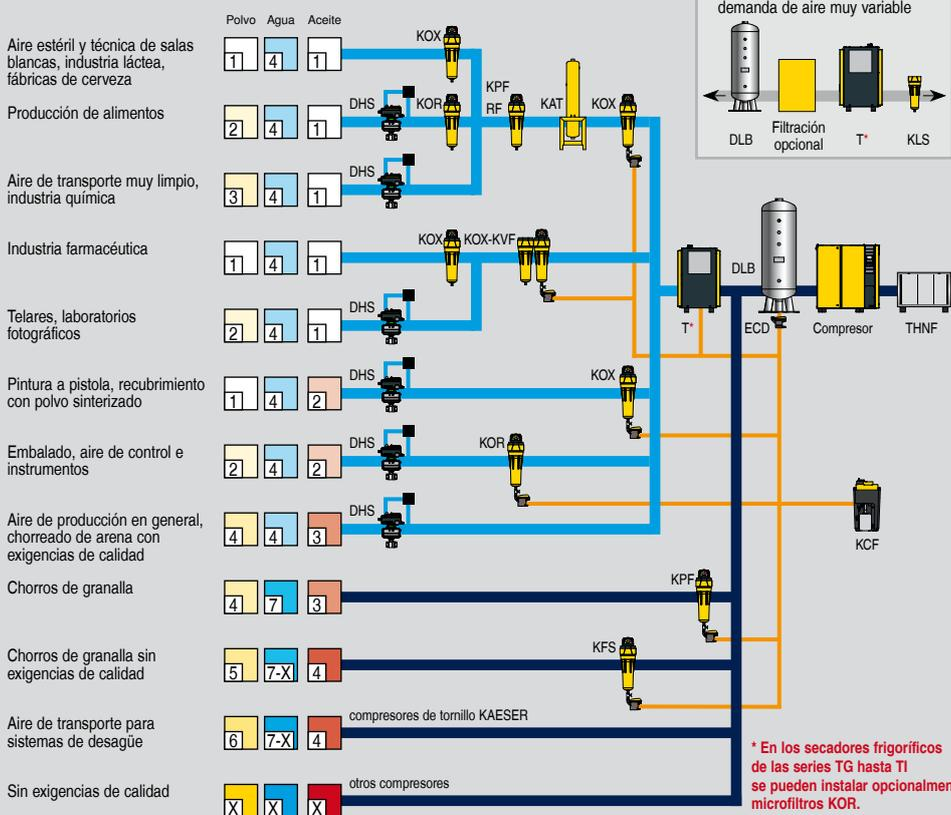
Para redes no protegidas contra congelación: Tratamiento del aire comprimido con secador de adsorción (punto de rocío -70 °C (-94 °F))
