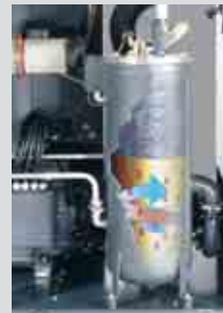
Las unidades CSD poseen un sistema de separación optimizado y alta eficiencia. La mayor parte de fluido de enfriamiento es separado del aire inicialmente por
