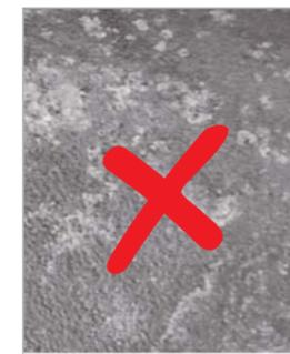
Recubrimiento simple: corrosión
