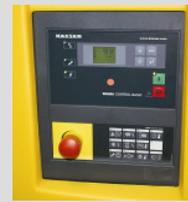
Una interfaz sencilla y confiable ofrece un control de presión y supervisión del sistema con despliegue de estado e indicadores de servicio. La pantalla incluye presión y temperatura de descarga, horas de carga y de servicio así como indicadores de falla.
