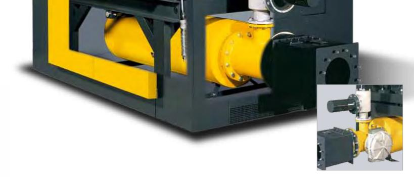
Los paneles desmontables de la cabina silenciadora ofrecen una cómoda accesibilidad para todos los trabajos de mantenimiento, por ejemplo para controlar y cambiar los filtros y el aceite o para revisar las bandas trapezoidales.
