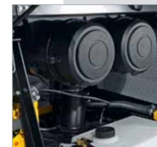
**Filtros de aire separados para motor y compresor**
